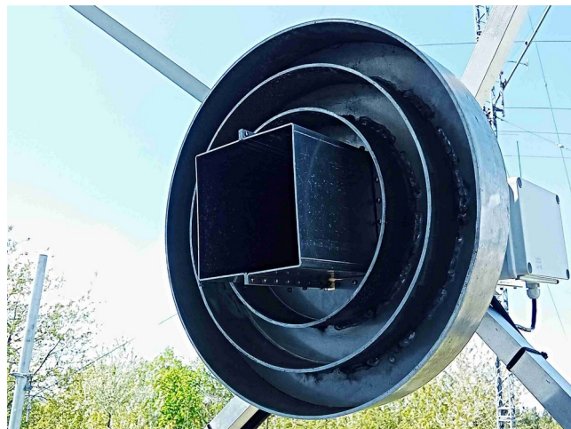
Pohled na ozařovač v parabole 4,4m OK1VUM
