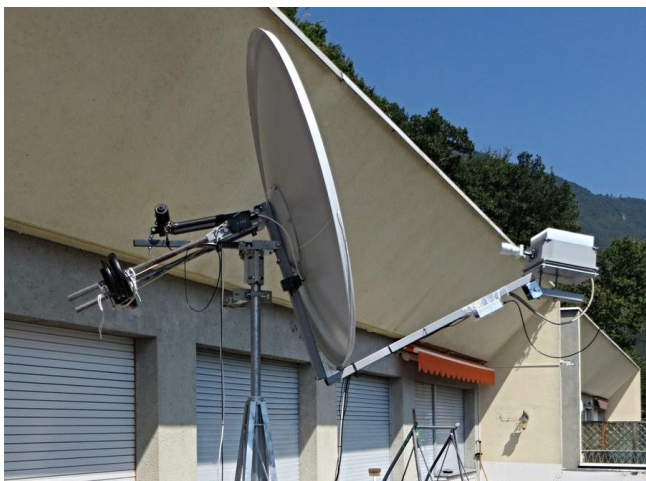
IW2BNA 1,5 offset parabola a 27W out
